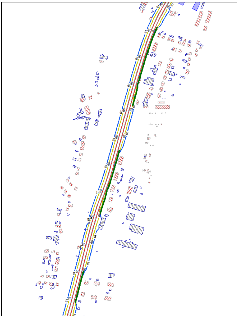
Ryc. 11.6. Zakres oddziaływania planowanej inwestycji od km 0+600 do 1+800 dla W1. (Źródło: Fragment wykresu z obliczeń programu SoundPLAN)
